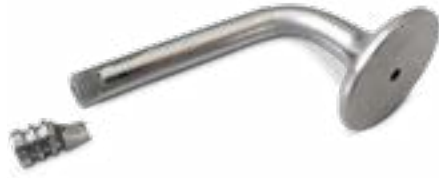
Şek. 1 Girintide yükten kaynaklanan kırılma
